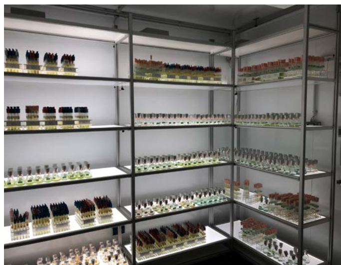
Abb.: Das neue Regalsystem wurde speziell für die Algenforschung entwickelt und musste deshalb die Möglichkeit zur Regulation von Helligkeit, Tag- und Nacht-Steuerung und verschiedenen Farbspektren aufweisen können.
